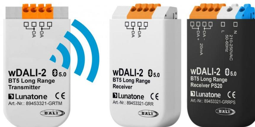
Cette nouvelle version de produit (2021) utilise la fonction Long Range du Bluetooth 5.0. En gros, en réduisant le débit (et en optimisant la bande passante), on augmente la portée radio. En Bluetooth 4.0, on dispose environ de 10m de portée maximum et en 5.0 de 40 à 50m (à valider selon les environnements). La fiche technique des produits reste sur 10-20m. Seule valeur sur laquelle nous pouvons nous engager à ce stade.
